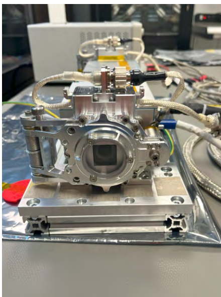
DP EM integrated with the camera EM
